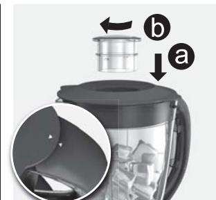
3. Chiudere il coperchio e (A) inserire il bicchierino dosatore nel foro di riempimento e (B) bloccarlo in posizione.
