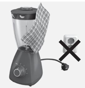
**Dokładne czyszczenie:** Wyłącz blender i odłącz go od zasilania. Przetrzycz obudowę silnika zwilżoną szmatką. **Nie wolno zanurzać obudowę silnika w wodzie ani myć go pod bieżącą wodą!**
